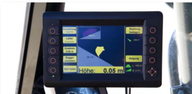
Das ifm-Dialoggerät CR1082 dient zur Anzeige und Dateneingabe, außerdem führt die integrierte SPS die Höhenberechnung durch.
