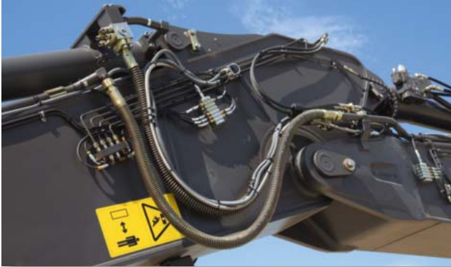
Je Baggerarm ermittelt ein Neigungssensor den exakten Winkel.
