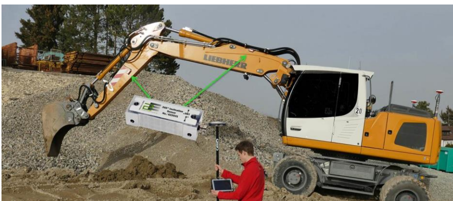
Erfassung der Positionsdaten am Bagger mittels Neigungssensoren
