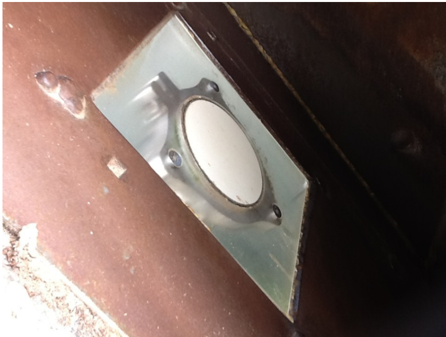
Bild 3: Messung durch Plexiglasscheibe
